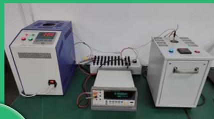
熱電対温度検査
