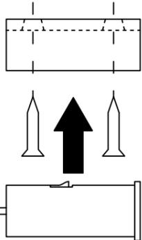
ホルダーから本体を取り外し、ホルダーをネジで木部に固定した後本体をホルダーに取り付ける。
