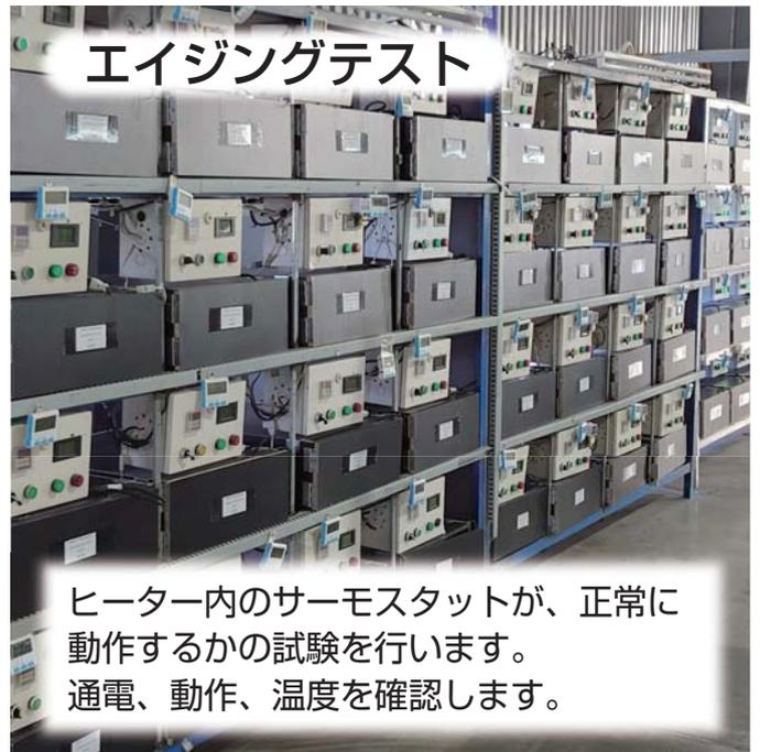
ヒーター内のサーモスタットが、正常に動作するかの試験を行います。
