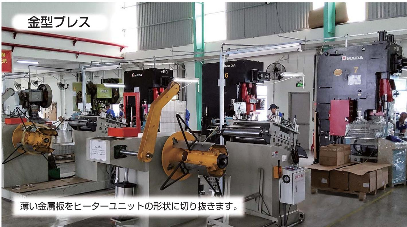
薄い金属板をヒーターユニットの形状に切り抜きます。
