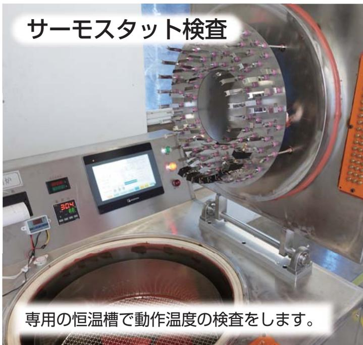
専用の恒温槽で動作温度の検査をします。
