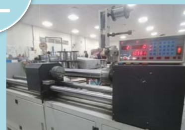
発熱線(ニクロム線)加工
