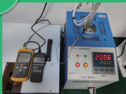
熱電対温度検査
